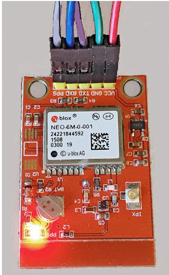
Fig. 3 GPS module header wiring
